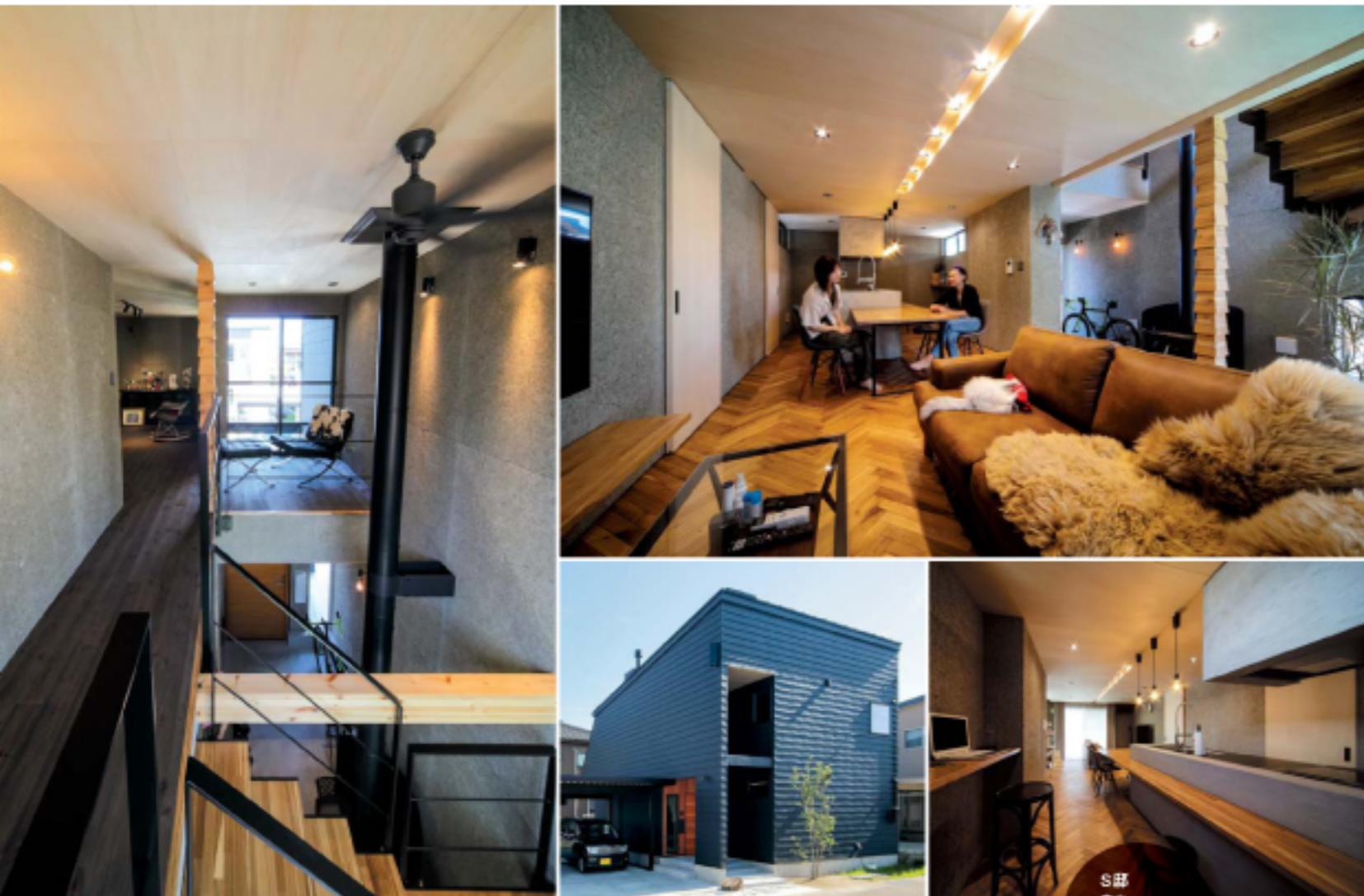
右頁/玄関を開けると、薪ストーブとバイクのある土間。視線はアイアンで制作したストリップ階段を介して外へと抜ける。左頁・右上/土間とオープンでつながるLDK。床はSさんの希望で無垢のホワイトオークをヘリンボーン張りに。右下右/コンクリートで制作したキッチンの前と、左手の壁際にはカウンター。右下左/外壁はガルバリウムを横張りにし、エントランスは吹き抜けに。左/2階の高窓にはセカンドリビングも。「長寿優良住宅」の認定取得が山内組の標準。
